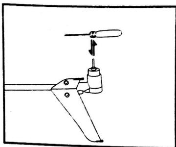
Ocasní rotor opatrně stáhněte z hřídelky motoru směrem nahoru. Nový rotor poté opatrně nasuňte na hřídelku. Dbejte, abyste při tom hřídel motorku neohnuli.
