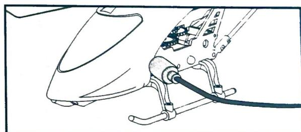
Nabíjení trvá cca 60 minut, nabíjecí kabel z vrtulníku odpojte, jakmile se LED v nabíjecím kabelu opět rozsvítí.
